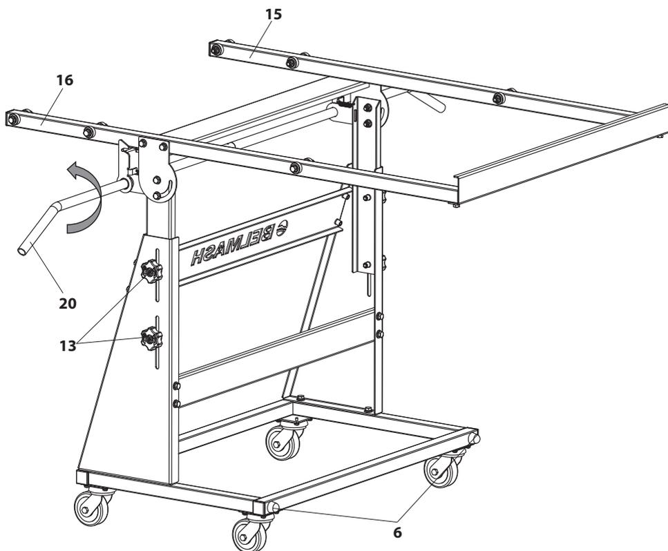
После установки заготовки, переведите рабочий стол подставки в горизонтальное положение, при этом направляющие 15 и 16 автоматически зафиксируются. Для возврата в вертикальное положение, необходимо удерживая за направляющую 15 или 16, повернуть ручку 20 по стрелке, опустить рабочий стол до упора в отбойники 6.
