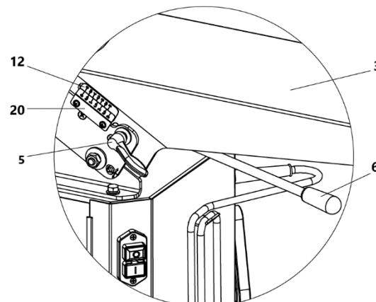
**Рисунок 6** Установка глубины фугования
