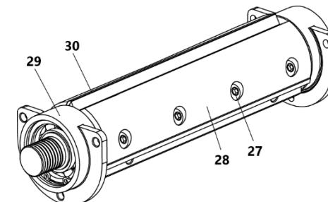
Рисунок 7 Конструкция ножевого вала
