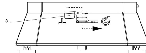
**Рисунок 5** Направление установки станка в транспортное положение
