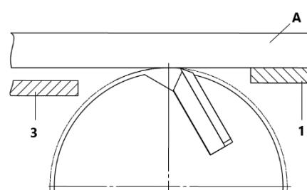
**Рисунок 11** Схема проверки ножей
