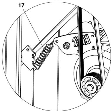
**Рисунок 4** Установка пружины
