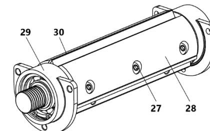
Рисунок 8 Конструкция ножевого вала
