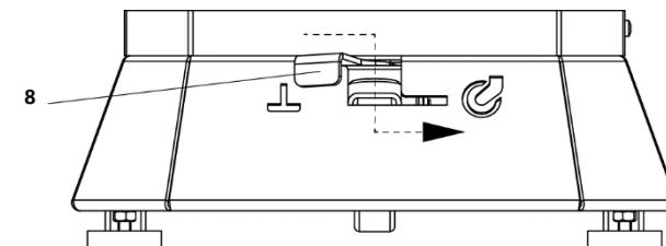
**Рисунок 6** Направление установки станка в транспортное положение
